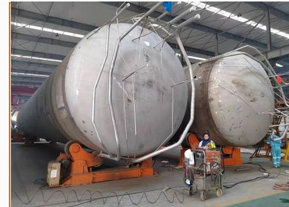
LNG Storage Tank Fabrication
