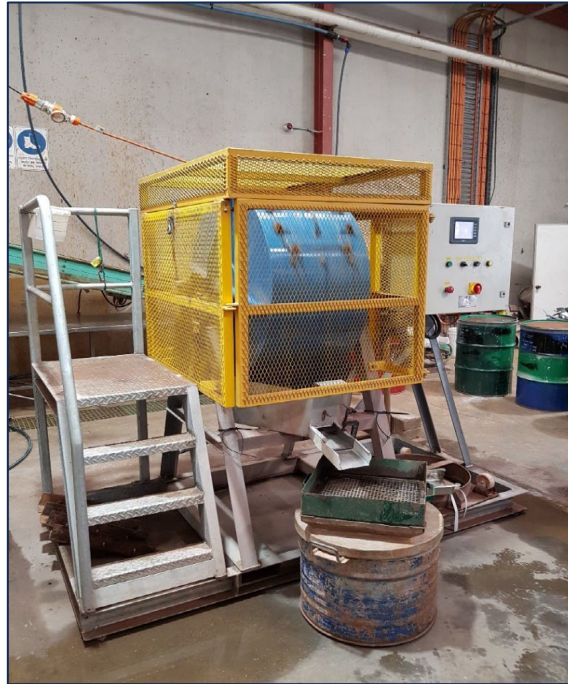
Figure 4. Drum Scrubber Set up at ALS Laboratory
